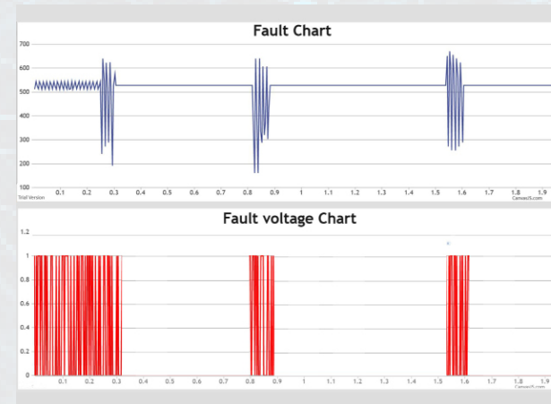
شکل ۱: سیگنال دریافتی از دستگاه نصب شده بعد از ریکلوز و هنگام رخداد خطا
